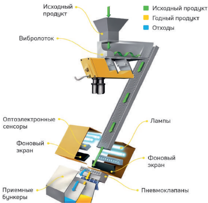
Рис. 4. Устройство фотосепаратора
